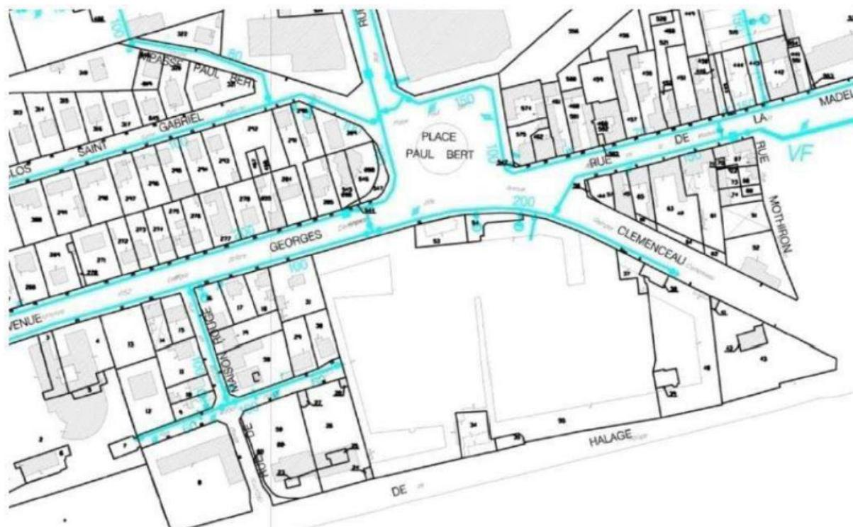
Figure 63 : Extrait du plan des canalisations d'eau potable
